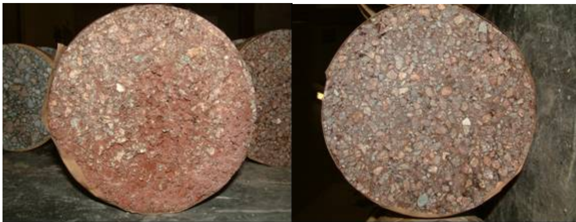
Figura 3: vista e sezione di provini tipo SMA “Antiskid” tiepido prelevati da campo prove sperimentale per il tappeto superficiale della pavimentazione della metrotranvia su gomma di Bologna (“Civis”).
